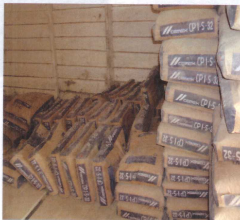
Figura 2 – Incorreto Acondicionamento do cimento
