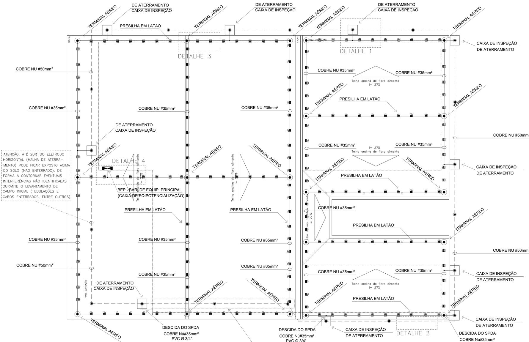
ATENÇÃO: ATÉ 20% DO ELETRODO HORIZONTAL (MALHA DE ATERRAMENTO) PODE FICAR EXPOSTO ACIMA DO SOLO (NÃO ENTERRADO), DE FORMA A CONTORNAR EVENTUAIS INTERFERÊNCIAS NÃO IDENTIFICADAS DURANTE O LEVANTAMENTO DE CAMPO INICIAL (TUBULAÇÕES E CABOS ENTERRADOS, ENTRE OUTROS).
