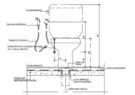
DETALHE INSTALAÇÃO DE BACIA COM CAIXA ACOPLADA
