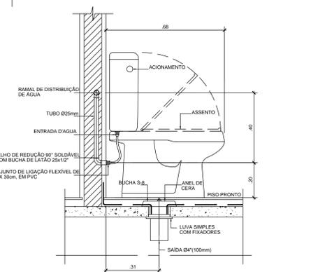
DETALHE INSTALAÇÃO DE BACIA COM CAIXA ACOPLADA
