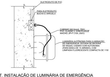
DET. INSTALAÇÃO DE LUMINÁRIA DE EMERGÊNCIA
