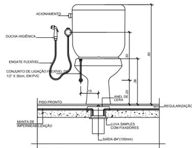
22 DETALHE INSTALAÇÃO DE BACIA COM CAIXA ACOPLADA
