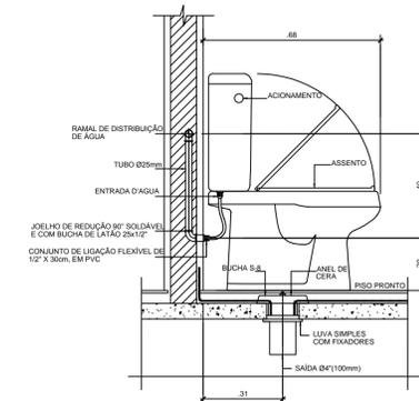
23 DETALHE INSTALAÇÃO DE BACIA COM CAIXA ACOPLADA
