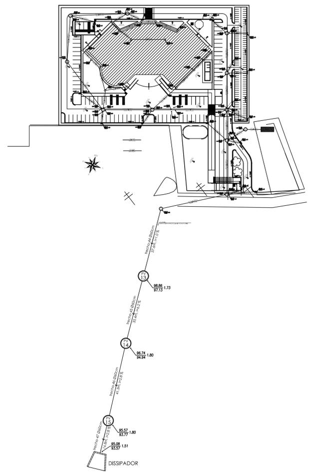
**02** PLANTA DE IMPLANTAÇÃO (geral) - ÁGUAS PLUVIAIS
