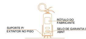
DETALHE DE INSTALAÇÃO DO EXTINTOR DE INCÊNDIO
