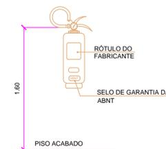
DETALHE DE INSTALAÇÃO DO EXTINTOR DE INCÊNDIO
