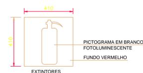
DETALHE DA SINALIZAÇÃO DO EQUIPAMENTO NA PAREDE
