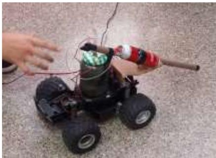
**Figura1:** Protótipo batizado como “Lopito”, funciona a base de hidrogênio.
