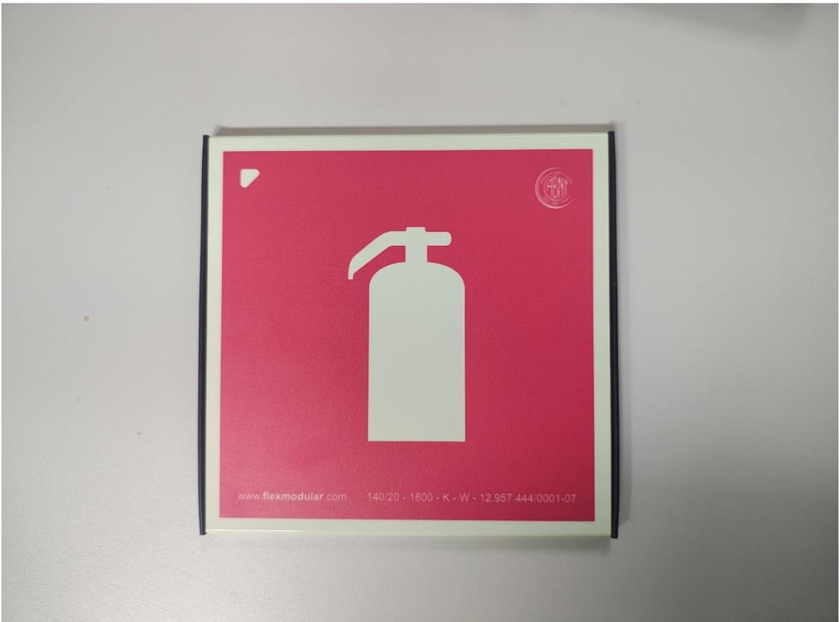
**08 - Amostra de modelo de placa intercambiável fotoluminescente de combate de agente extintor com acabamento lateral m tampa de ABS injetado de 3 mm de largura frontal e 10 mm de profundidade. Personalização das informações fixas por meio de vinil adesivo fotoluminescente e impressão digital em tinta com cura UV, conforme item 4.1 da ABNT NBR 168020 2020, med. 0,25 x 0,09 m.**
