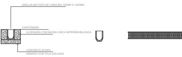
DET.02 - CANALETA E GRELHA ESCALA 1/25
